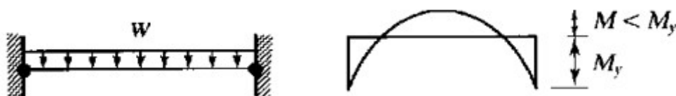
شکل ۴۶، تشکیل مفاصل پلاستیک در دو انتهای تیر و شروع فرآیند باز توزیع لنگر
